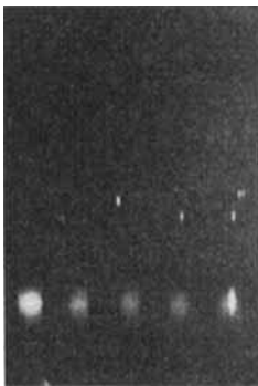
Fig. 6. Chromatogramm von 4 bekannten 3,4-Benzpyrenlösungen und einer unbekanntten Lösung in der Reihenfolge von links nach rechts im UV.-Licht photographiert
